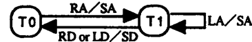
(c) ルートの一方向に対する中継ノードの状態遷移図
