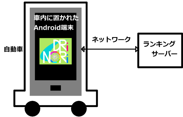
図 2 DRiNORi を車載モードで使用する構成
