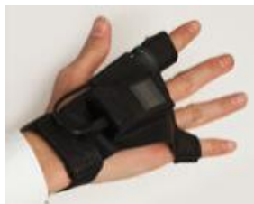
図 3 グローブ型スキャナの装着例 Fig 3 Example of glove type barcode reader
