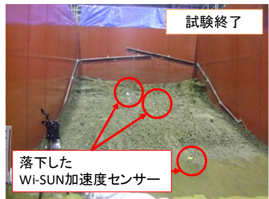
図5 Wi-SUN 加速度センサーの設置場所 (大型土槽)
