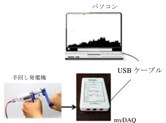
図 2 ゲームのシステム構成 Fig. 2 A configuration of the game system.
