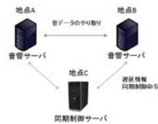
図 3 音声伝送サーバの構成例。
