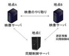
図 6 映像伝送システムの構成例.
