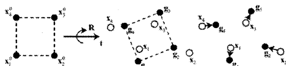
図 2. 現在の形状 (位置 \mathbf{x}_i ) に最も近づく移動 \mathbf{t} と回転 \mathbf{R} から目標形状 (位置 \mathbf{g}_i ) を求め、各パーティクル i に \mathbf{g}_i へ近づけるような力を加える。
