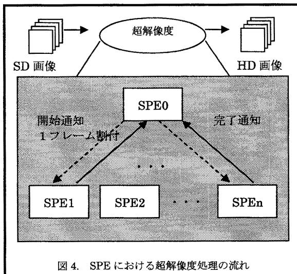
図4. SPEにおける超解像度処理の流れ
