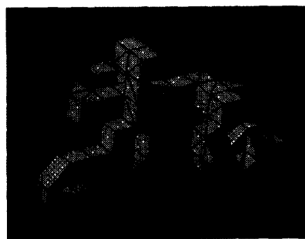
図 5-2 タンク内のブロック g = 150 , d = 100 で 2000 タイムステップ後。結合面で覆われた枝状の構造が特徴。
