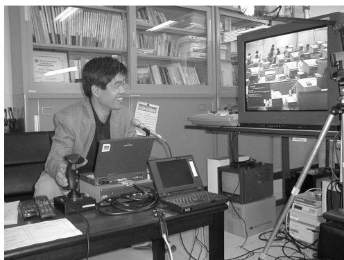
図 4 CRCP ジョイスティッククライアントを使用した遠隔講義実験の一場面
