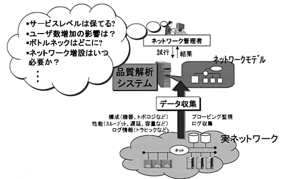
図2 IPサービス品質の評価/予測システム Fig.2 IP Service level evaluation/prediction.
