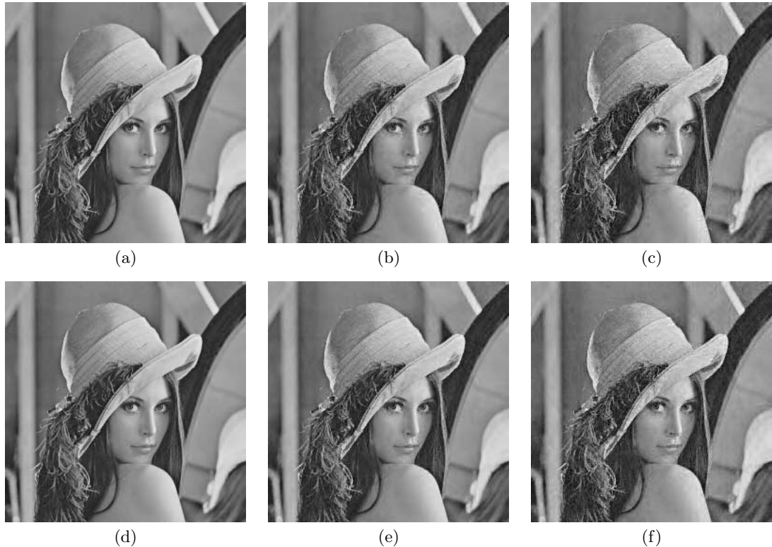
図3 Lenaを用いた実験結果：(a) EZW 圧縮画像 (0.59 bpp)，(b) (a) への21%埋め込み結果，(c) 33%埋め込み結果，(d) EZW 圧縮画像 (1.15 bpp)，(e) (d) への26%埋め込み結果，(f) 38%埋め込み結果
