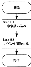
図10 命令セットレベル 命令セット生成フロー
