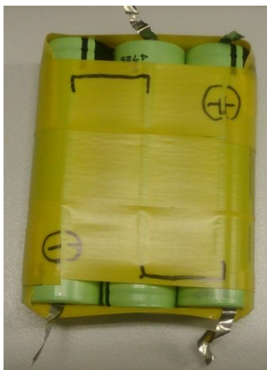
図9 バランスを実行した組電池 (一部)
