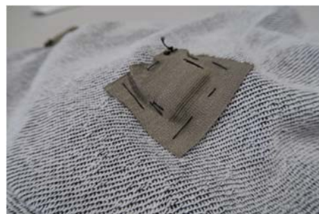
図 7 導電繊維を使った電極 Figure 7 Conductive textile electrodes
