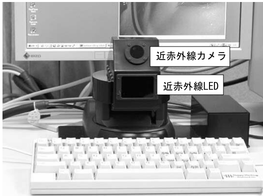
図 8 試作した視線測定システム FreeGaze
