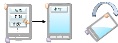
図2 水溶液の選択と加速度センサによる傾き
