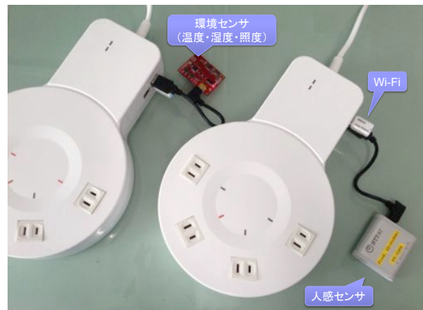
図1: 各種センサのスマートタップへの導入
