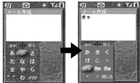
図 11 プロトタイプ 3 の子音・母音文字入力インタフェース Fig. 11 Interface of consonants and vowels input for Prototype 3.
