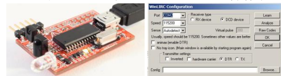
図5 赤外線受信モジュール(左)と制御ソフト(右)
