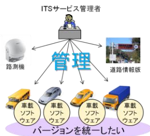
図1 管理された機器によるネットワークでのバージョン統一 例: 車載・路上機器によるネットワーク
