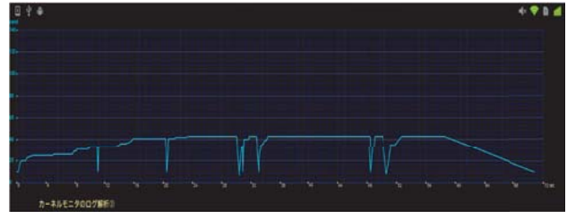
図 4: Android1 の輻輳ウィンドウ (輻輳制御変更時)
