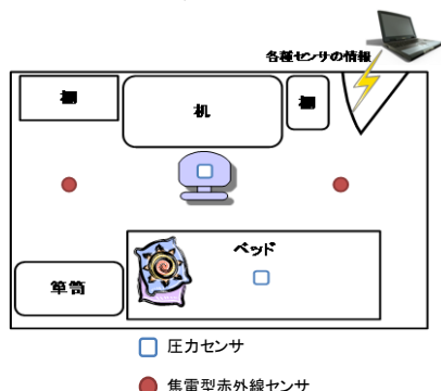
図2 センサ利用位置検出方式の構成図
