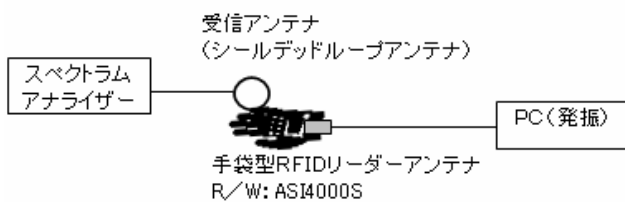
図 3. 磁界強度測定の実験構成
