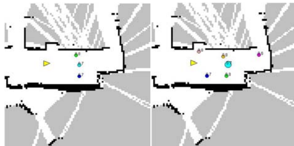
Fig.3 : (左)3人の時,(右)6人の時の人物位置推定結果
