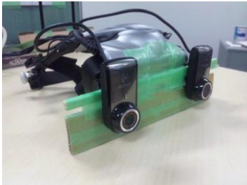
図2: 左右にカメラが取り付けられたHMD
