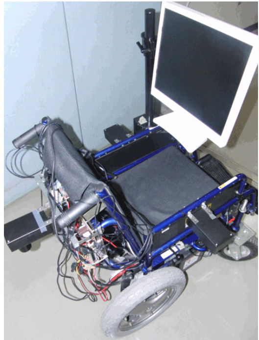
図 1 カメラとモニタを搭載した電動車椅子
