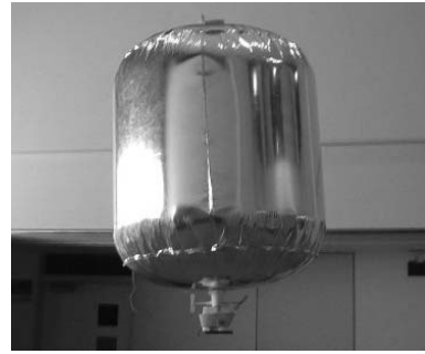
図 2 円柱型バルーンロボット Fig. 2 Pillar-type balloon robot.
