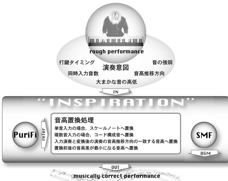
図 2 システム概要 Fig.2 System overview of INSPIRATION.
