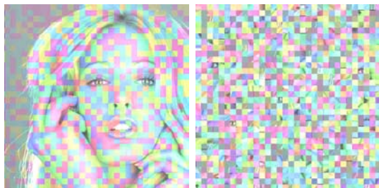
(c) 色成分間スクランブル ( C_x = C_y = 16 ), (d) 混合スクランブル ( B_x = B_y = 16 , C_x = C_y = 16 ).
