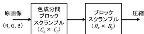
図 4: 混合スクランブルの処理手順。
