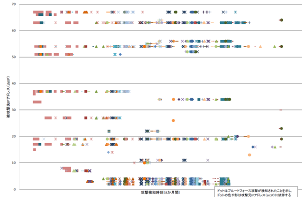
図 2: 3389 番ポートに対する BF ログから抽出できた EBF に類似した事象
