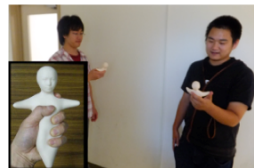
図1: 携帯型遠隔操作アンドロイド「エルフォイド」[2]
