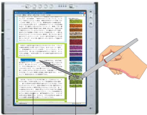
図 2 提案した Overview+Detail ドキュメントインタフェース Fig. 2 Proposed Overview+Detail document interface.
