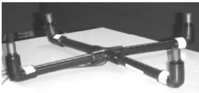
図 2 マイクロフォンの構成と概観 Fig. 2 Microphone array.
