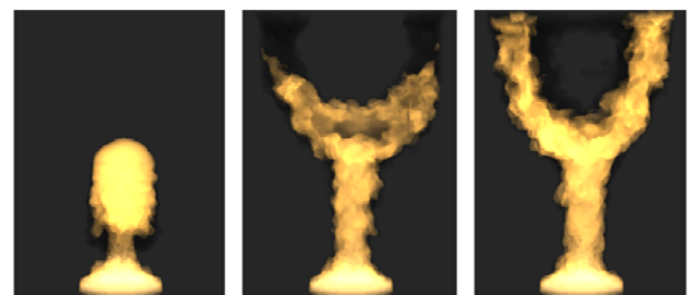
図 5 : Y 字形状に制御された炎のシミュレーション結果
