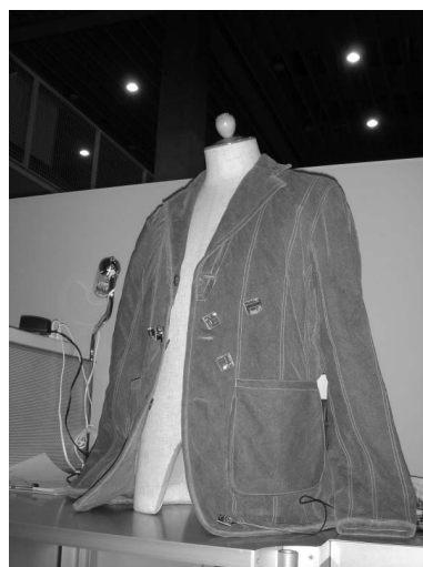
図 8 試作した導電性布地を用いたジャケット Fig. 8 Prototype jacket with conductive cloth.
