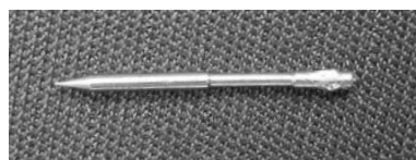
図 9 試作した接合部分の絶縁針 Fig. 9 Prototype pin with insulator.
