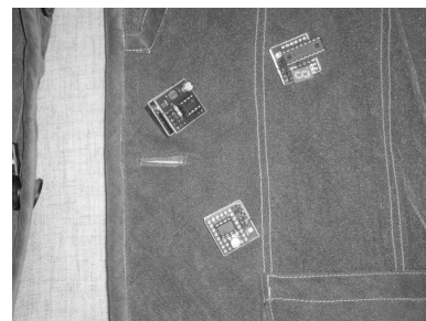
図 11 試作したジャケットに衣服装着型デバイスを装着して動作させた状態
