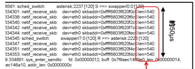
図 11 ftrace によるパケット滞留の確認
