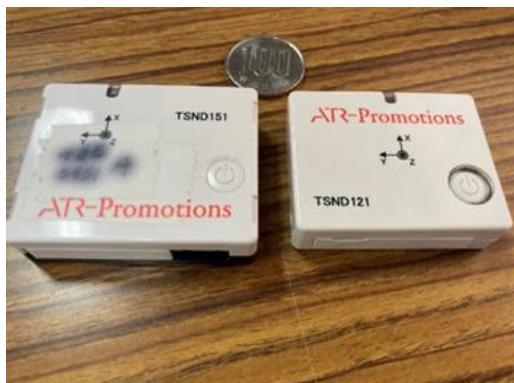
図6 実験に使用したウェアラブルセンサ
