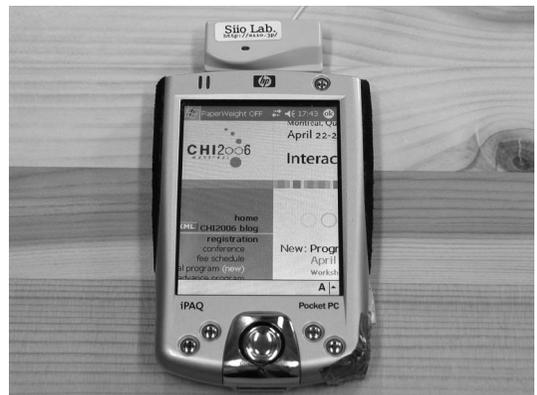
図 4 文鎮メタファによるスクロールモード切替えを実装した WWW ブラウザ
