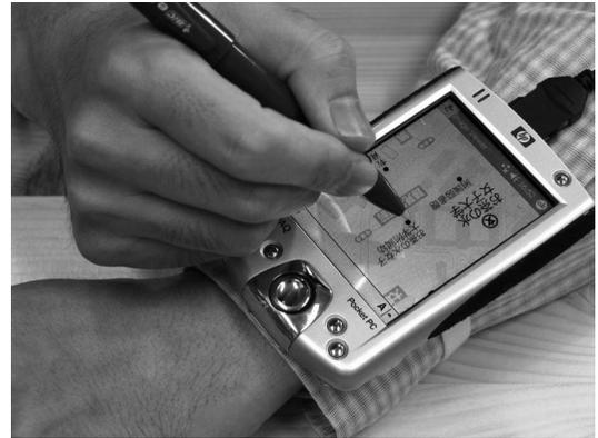
図6 腕装着型ウェアラブルコンピュータへの応用。文鎮メタファは片手操作が必須の状況で効果的である
