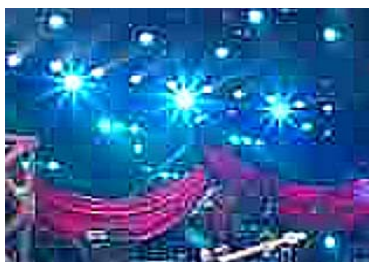
図2 削減対象とするブロックノイズの例 Figure 2 An Example of Block Noise
