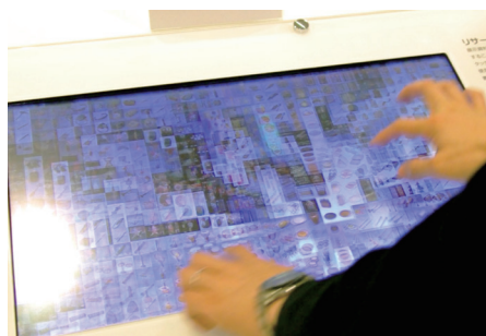
図 5 ピンチアウト操作による画面の拡大例 Figure 5 Example of Zooming-in by Pinch-out Operation.
