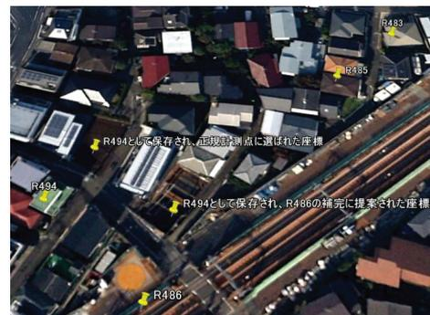
図 15  $CASE_W$  の誤計測点修正の例
