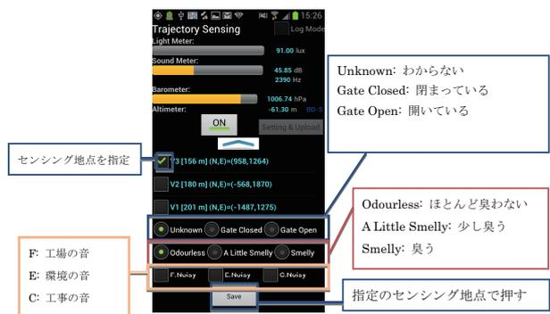
図 3 明示的な計測点指示による測定方法
