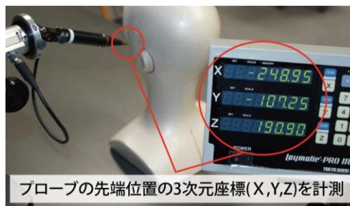
図6. レイアウトマシンによる計測
