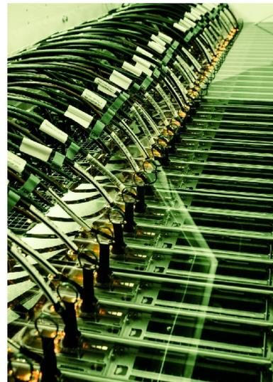
図 2 GRC Carnot Jet システムの油槽の中に計算サーバが浸された様子
