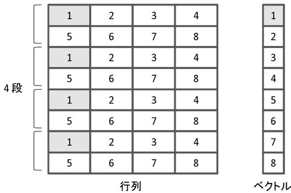
図 3 行列とベクトルの 2 次元分割例．編み掛けの部分がプロセッサ 1 に割り当てられるデータである．
