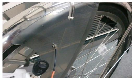
図 3 光電センサを取り付けた自転車
