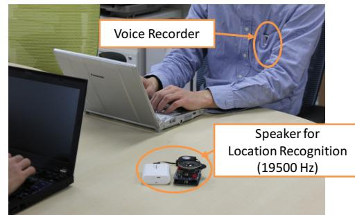
図 2 位置認識用スピーカーの配置の様子
