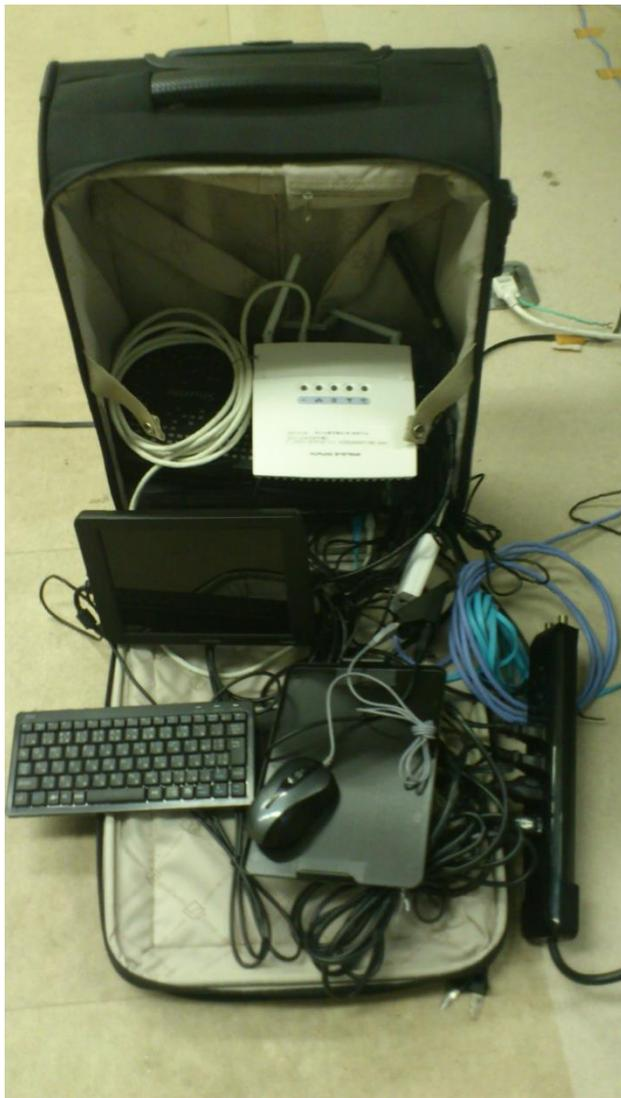
図 2 試作したポータブルクラウドの内部
