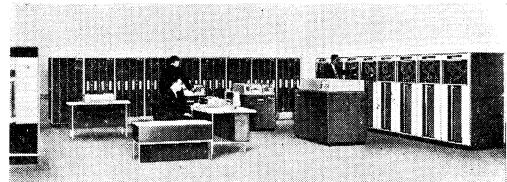
命令は 1 アドレス方式で、基本的なものは 100 種類程度であるが、これを複合させることにより 2400 種類以上になり、99 箇のインデックスレジスタと浮動小数点演算装置が使用できるので、事務処理のみならず複雑な科学技術計算に適用できる。しかも AUTO-CODER, FORTRAN 等のプログラミング方式が準備されているので、プログラミングは容易である。
