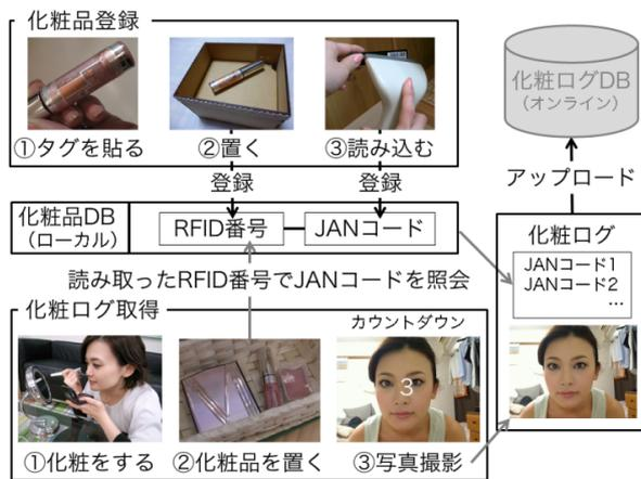
図 4 Smart Makeup Logger のシステム概要図
